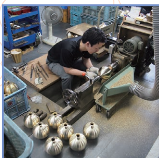
【写真②】ろくろを使って一つ一つ磨き上げる
