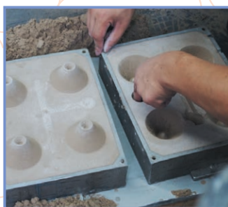
【写真①】木型の周りに砂を突き固め、木型を抜き取ることで鑄型ができる
