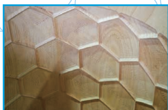
胴抜き後、「亀甲彫り」や「波動彫り」と呼ばれる彫刻を施すことによって、太鼓の残響をよくする効果がある
