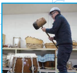
その状態のまま革面を槌で叩いて張り加減を調整する
