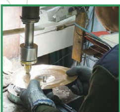
ハンマーでたたく作業。機械を使って、速さと圧力を統一している
