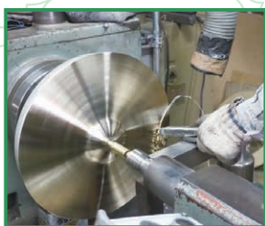
種類に応じて、それぞれの厚さに調整する作業
