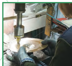
ハンマーでたたく作業。機械を使って、速さと圧力を統一している
