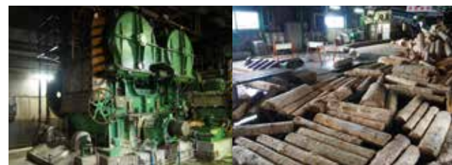
機械パルプを作るマシン。 上階には水に浮かべられた原料の丸太がある
