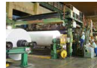
抄紙機の最後の工程。6m幅の状態で紙が巻き取られる
