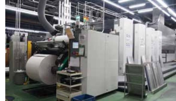
「輪転機」と呼ばれる印刷機。製紙工場で作られた筒状の紙がセットされている
