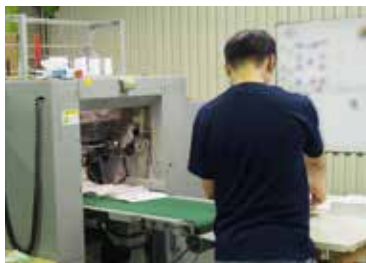
機械の上部に固定された糸でかがられていく
