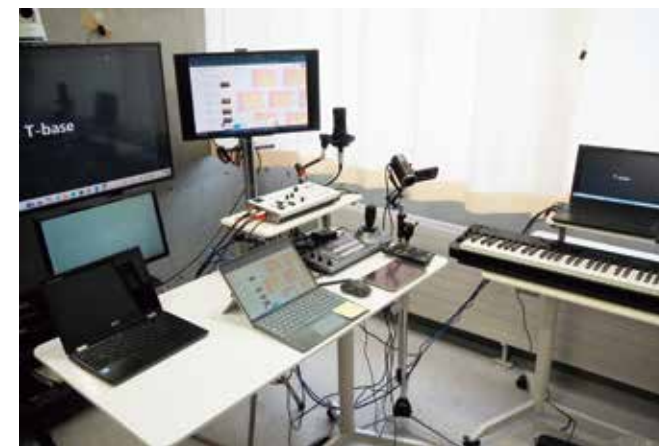
遠隔授業に使用される機材。スイッチャーを用いて配信用カメラの切り替えや、受信校側のカメラの操作などもできる
