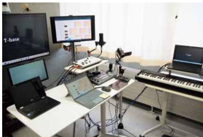
遠隔授業に使用される機材。スイッチャーを用いて配信用カメラの切り替えや、受信校側のカメラの操作などでもできる
